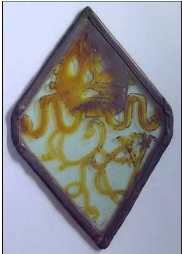
Abb. 2011-2/210 Butzenscheibe mit Abriss (Butze), hellgrün, mit Lufteinschlüssen, Schlieren und Korrosion D ca. 9,7 cm, Glasdicke neben dem Abriss ca. 0,4 cm Glasdicke am Rand ca. 0,1 cm umgeschlagener Rand Dicke ca. 0,2 cm, Breite ca. 0,5 cm Foto: Horst Mayer, Netphen
