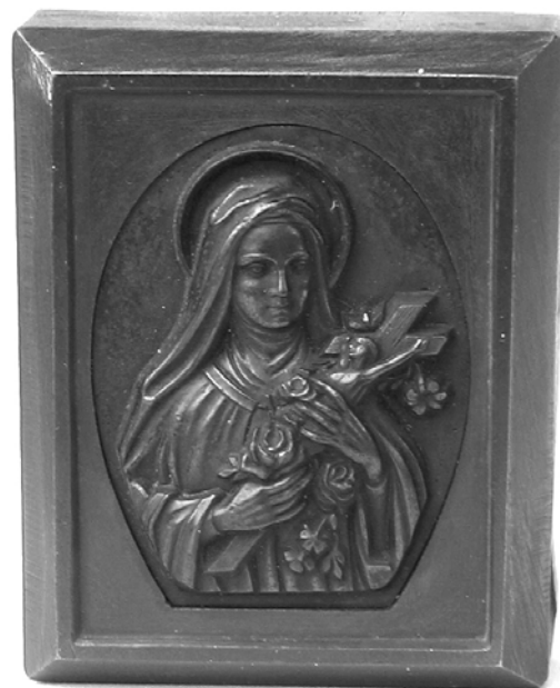
Abb. 2001-03/659 Pressform Hl. Theresia von Lisieux, rechteckig Motiv in der Pressform erhöht, Stahl 72 / 55 mm ähnl. Motiv mindestens seit 1939 s. MB Hoffmann 1939, Tafel 7, Glas Nr. 110 Curt Schlevogt, Krumpendorf WS., nach 1948 Sammlung Ingrid Schlevogt
